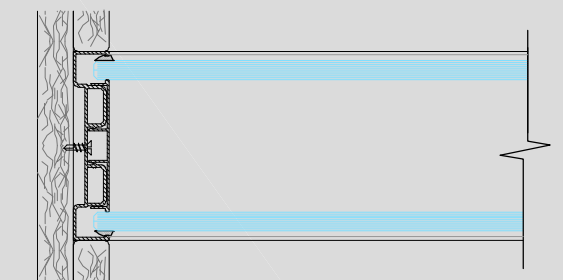
Arranque desde puerta vidrio enmarcado (100 mm) Start from a 100 mm thick framed glass door
